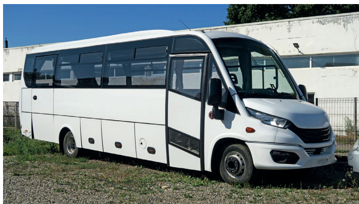
Aveuro réalise des midibus à partir de châssis-capot Iveco Daily. C'est la version scolaire pour 33 passagers qui intéresse le plus le marché français.
