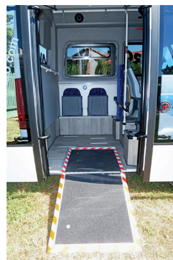
L'ajout d'un accès low entry dans le porte-à-faux arrière convertit un eSprinter en minibus urbain de 7 m.
